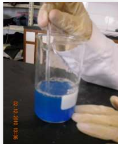
Figura 12- Dissolução do Sulfato de Cobre II em água
