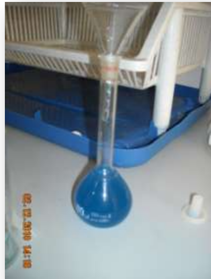
Figura 14- Preparação da Solução aquosa de Sulfato de Cobre II
