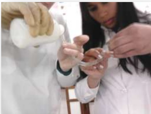
Figura 17- preparação da ponte Salina para as 3 pilhas
