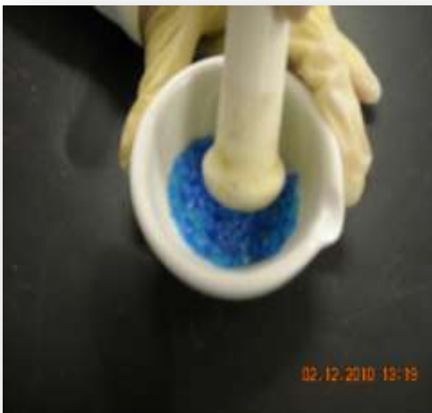
Figura 11- Moagem do Sulfato de Cobre II
