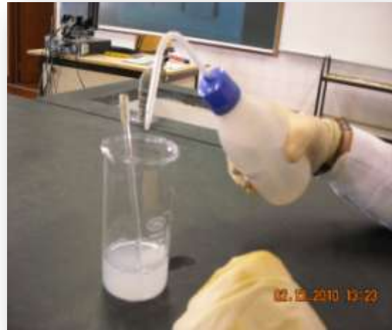
Figura 8- Preparação da solução de sulfato de Zinco
