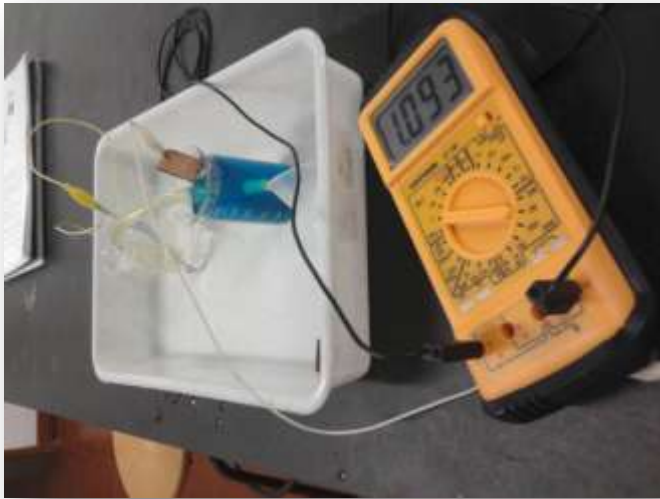
Figura 19- Montagem da Pilha – 1ª pilha (temperatura Ambiente)- d.d.p- 1,093V
