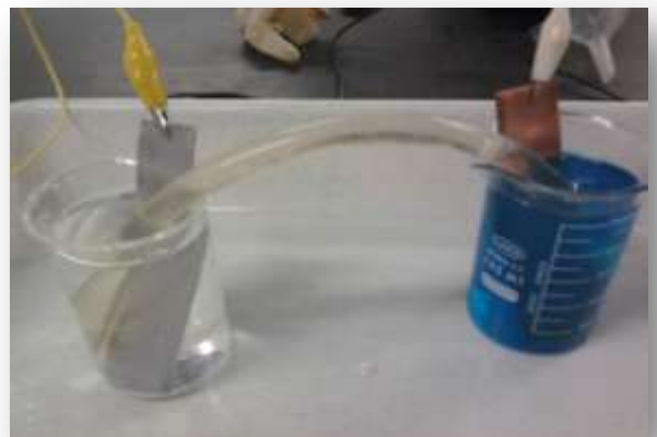
Figura 18- Montagem da Pilha – 1ª pilha (temperatura Ambiente)
